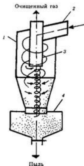
1 – корпус; 2 – входной патрубок; 3 – выхлопная труба; 4 – сборник пыли
