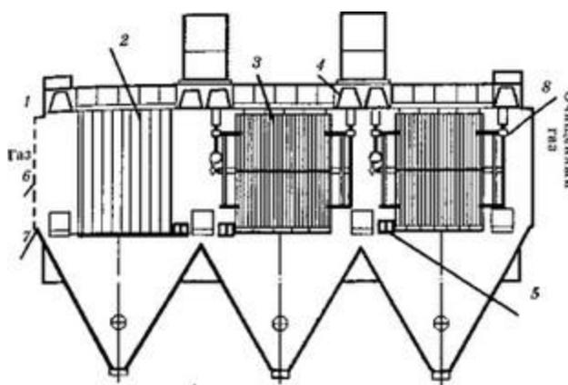
1 – корпус; 2 – электрод осадительный; 3 – электрод коронирующий; 4 – механизм встряхивания коронирующих электродов; 5 – механизм встряхивания осадительных электродов; 6 – газораспределительная решетка; 7 – сборник пыли; 8 – изолятор
